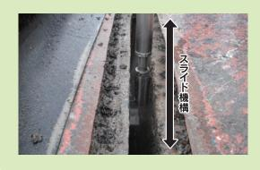
遠隔ロボット操作による確実な作業、噴射ノズルのスライド機構により、狭小空間での安全で安定した施工を可能にします。
